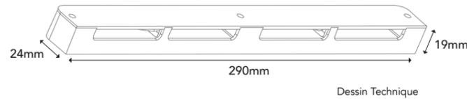
Sur les côtés extérieurs et intérieurs de la fenêtre, on ne voit pas les grilles de ventilation. Ainsi, l'architecture intérieure et extérieure ne s'altère pas comme c'est le cas avec les systèmes de ventilation traditionnels.
